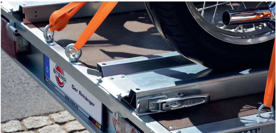
STLP 850 verfügt über vier zusätzliche versenkbare Verzurrbügel
