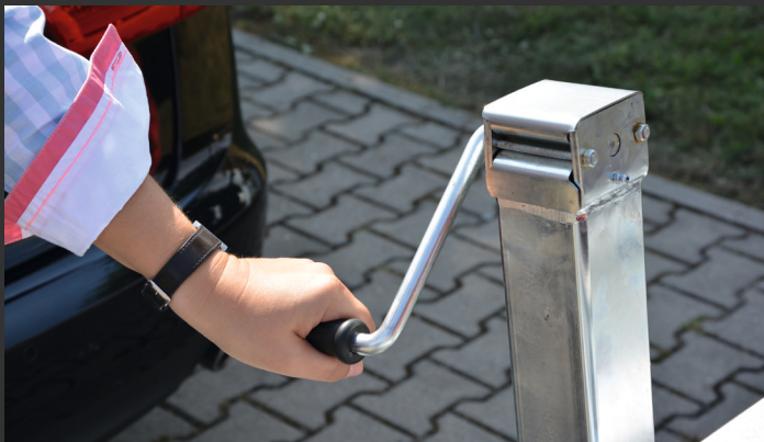
Durch Betätigen der Handkurbel wird die Kippbrücke einfach in die gewünschte Position gebracht.
