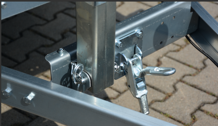
Befestigung der Kippbrücke über Sicherungsspannverschluss.
